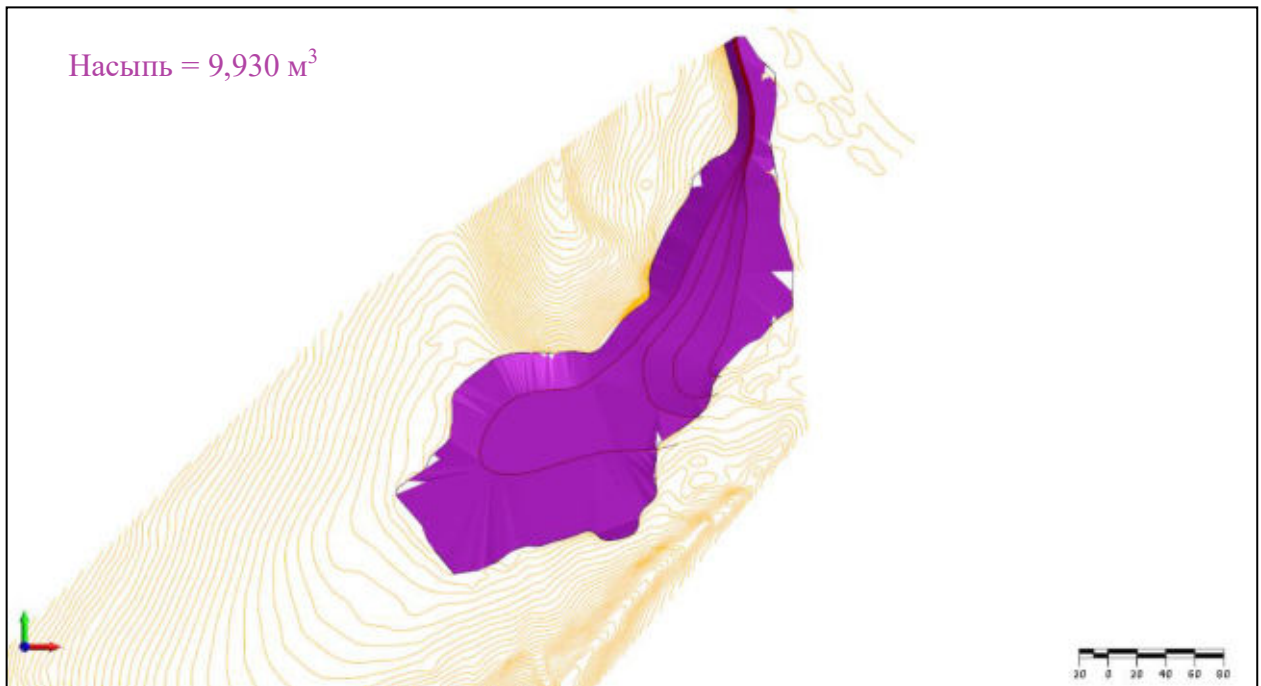
Рисунок 9 - Объем насыпи слоя глинистых грунтов (+0,4 м)
